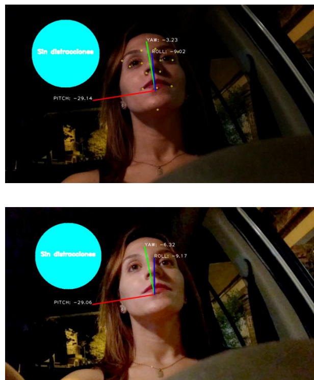
Fig. 3.10: Capturas nocturnas sin corrección Gamma y con corrección Gamma correspondientemente.
