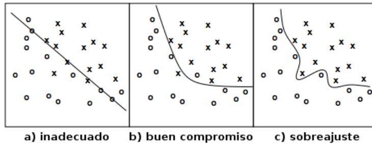
Figura 2.2: Tipos de ajuste que puede lograr un modelo sobre los datos que utiliza para su entrenamiento.
