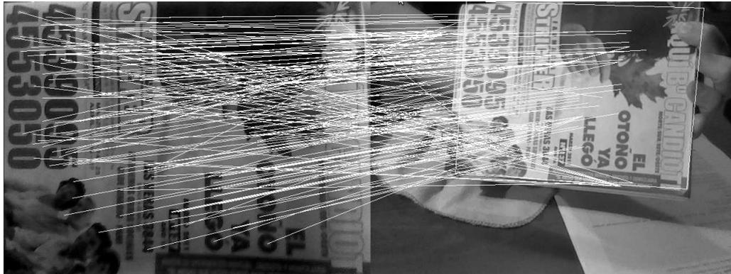
Figura 3.6: Correspondencias de puntos entre imágenes patrón y objetivo antes de estimar la homografía con RANSAC.
