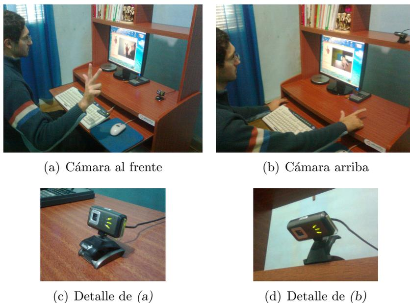
Figura 6.2: Posición de la cámara respecto del usuario. (a) Al frente, (b) Arriba (posición elegida para el Tutor) (d) y (e) Detalle de la posición de la cámara web.
