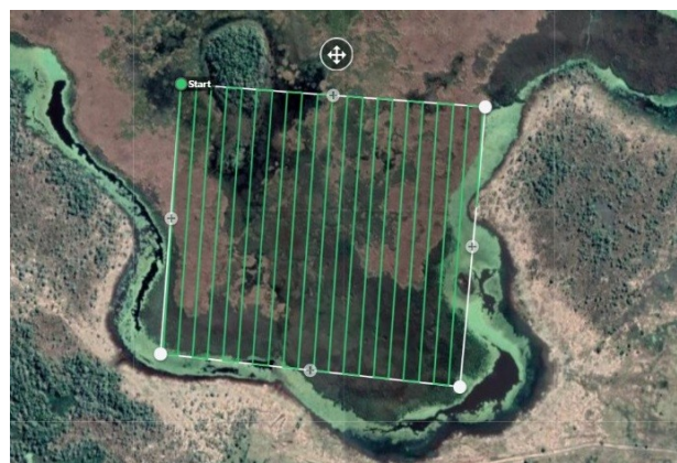
Figura 4: Trazado de ruta poligonal. Los vértices marcan posiciones de cambio de dirección en la trayectoria.
