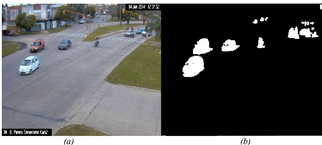
Figura 4.5: Ejemplo de segmentación. (a):fotograma, (b):máscara de segmentación.
