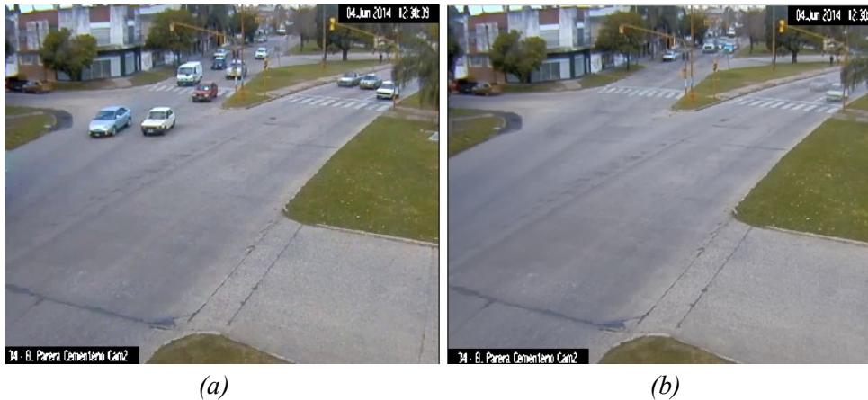
Figura 4.4: Ejemplo de modelado del fondo. (a): fotograma, (b): máscara de segmentación.
