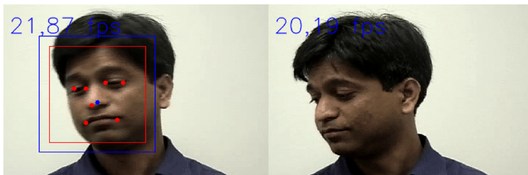
Figura 5.1: Detección de los puntos de interés a pesar de la rotación de la cara (izquierda) y error en la detección de los puntos de interés debido a demasiada rotación (derecha).
