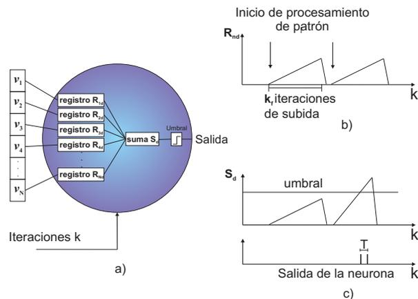
**Figura 2.** Diagrama estructural y funcional de la neurona detectora. a) representación de la estructura interna de la neurona. b) evolución de los registros una vez presentado un patrón con un  $\nu = 1$  en el coeficiente correspondiente a ese registro. c) registro suma junto con el umbral, spikes a la salida y período refractario
